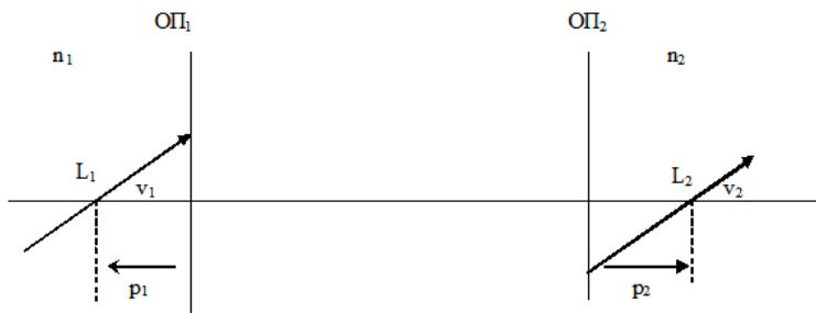
Рис. 2.19. К определению узловых точек оптической системы
